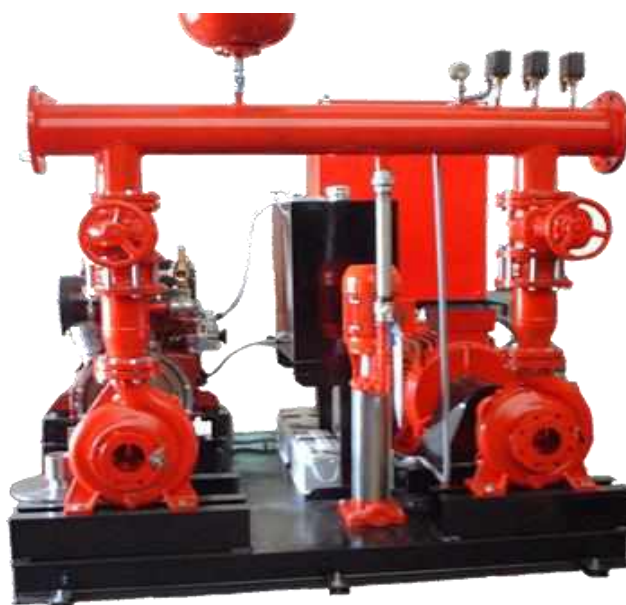
GRUPO BOMBA JOCKEY (2HP) + ELECTRICA (6,5HP) UNE 23-500/90 Hmax: 84Mt - Hmin: 16Mt - Qmax: 22m3/h
